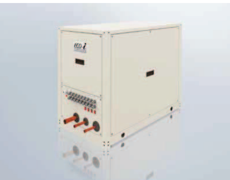
Firma Panasonic oferuje dedykowane rozwiązanie umożliwiające szybką i prostą instalację. Jednostka jest wyposażona w 5 wykonawczych zaworów kulowych, zbiornik magazynowy o pojemności 30 l i sterownik programowalny PLC – wszystko w obudowie o stopniu ochrony IP54. Zacziski z przodu jednostki pozwalają na proste wykonanie oprzewodowania do zacisku sygnału alarmowego, przetworników wysokiego / niskiego ciśnienia oraz czujników temperatury wylotowej jednostek kondensacyjnych.
